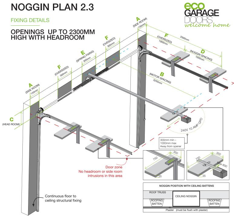
\*\*ALL NOGGINS MUST BE FLUSH WITH BACK SIDE OF PLASTER - NO CAVITY\*\*
