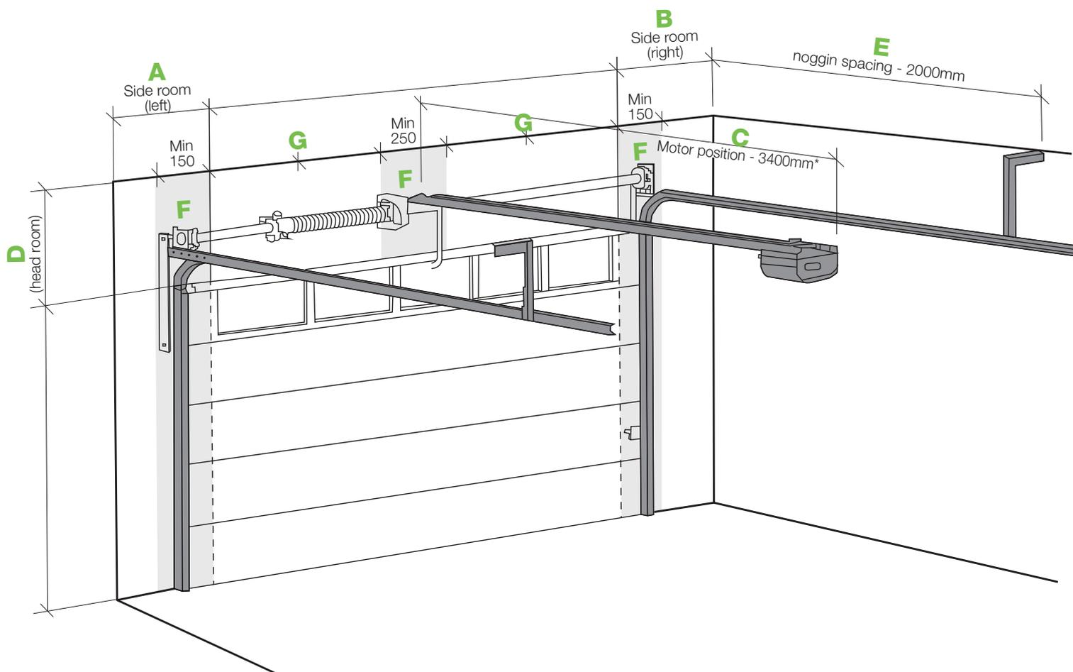
**\*\*ALL NOGGINS MUST BE FLUSH WITH BACK SIDE OF PLASTER - NO CAVITY\*\***
